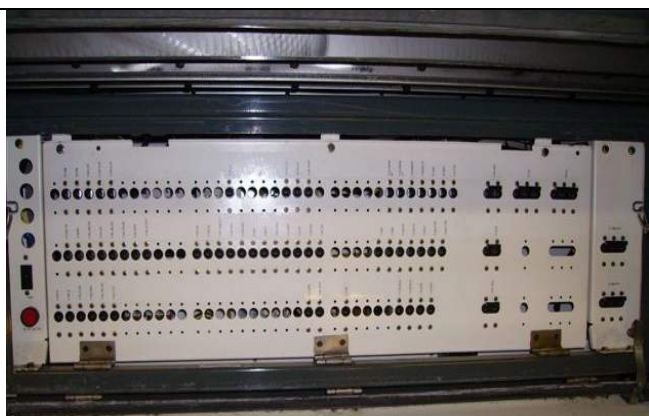
COFFRE BASSE TENSION (côté gauche) contenant les microdisjoncteurs de la voiture
