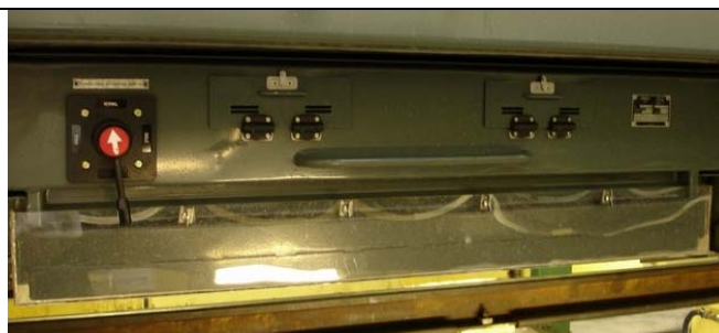
COFFRE BATTERIE et COMMUTATEUR D'ISOLEMENT BATTERIE (KISBA)
